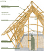
1. Se va fijando la estructura superior de la edificación con la estructura base (2). Se coloca una estructura de bambú horizontal que permitirá el paso.
